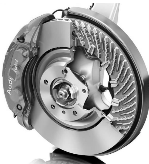
Fig. 1.2. Exemplu de sistem de frânare cu discă [104]
