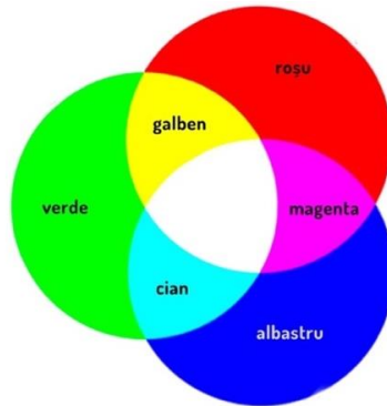
Fig. 1.6 Amestec aditiv al luminii: 3 surse cu intensități identice, în culorile roșu pur, verde pur și albastru pur, se amestecă aditiv rezultând o lumină albă (sursă imagine: licență CC0 1.0)
