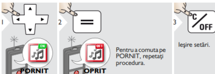
Fig. 14. Setarea semnalului sonor pentru tasta pornit/oprit
