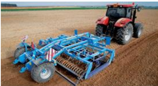
Combinator complex pentru pregătirea patului germinativ ( https://www.farmet.cz/ro/combinator-pregatire-pat-germinativ-kompaktomat-ps )
